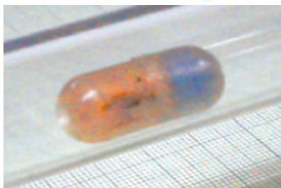
小腸に見立てた管内を走行する自走式カプセル
