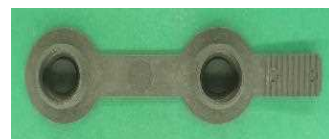
包材製造過程で出る廃材を 包材に活用した試作品
