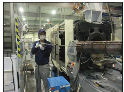
射出装置旋回加熱筒清掃
