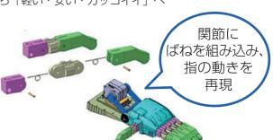
〈北九州大学との共同試作品〉 炭素素材により剛性を持ちながら、 軽量化を図っています。
